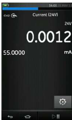
Рисунок 2-16. Измерение тока на CH2 на внутреннем контуре питания (диапазон: \pm 55 мА)
