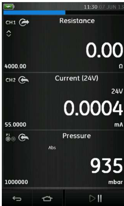
Рисунок 2-8. Окно калибратора (уменьшенный вид)
