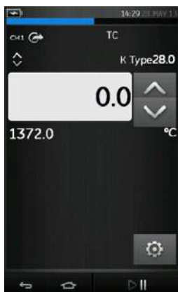
Рисунок 2-22. Измерение температуры терморезистора 21К-типа на CH1 (диапазон от -270 до 1372 °C)
