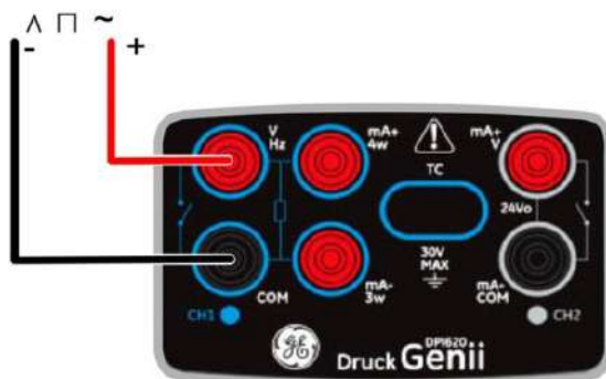
Рисунок 2-17. Пример А, измерение частоты на CH1 (диапазон 0—50 кГц)
