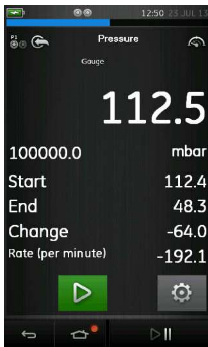
Рисунок 3-7. Пример тест герметичности
