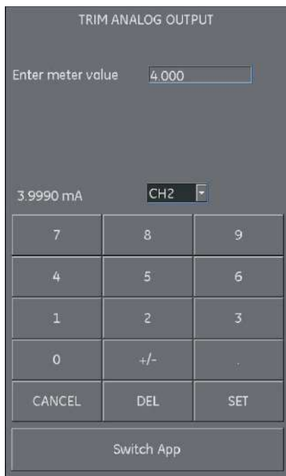
Рисунок 6-9. Ввод точки калибровки
