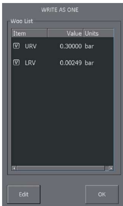
Рисунок 6-7. Выбор переменной записи Hart
